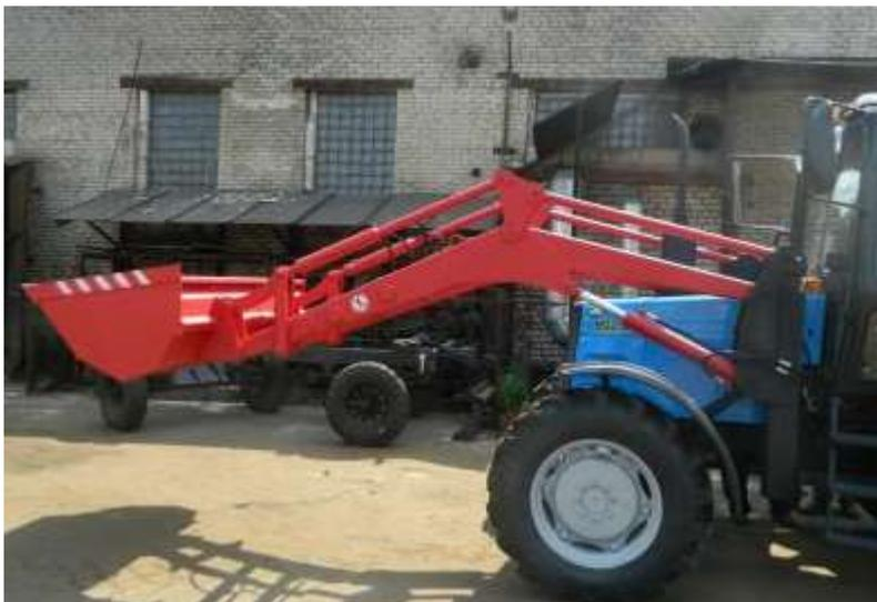
Номинальная грузоподъемность погрузчика, кг 900 Высота шарнира максимально поднятого ковша, мм 4250 Глубина врезания отвала погрузчика, не менее, мм 100 Ширина жесткого отвала погрузчика, мм 2000 Высота жесткого отвала погрузчика, мм 680 Масса погрузочного оборудования (без сменного навесного инструмента), кг 680 Высота разгрузки при макс. опрокидывании чел. ковша, мм 4100 Высота разгрузки при макс. опрокидывании ковша, мм 3200 Вырывное усилие погрузчика, кгс 1000
