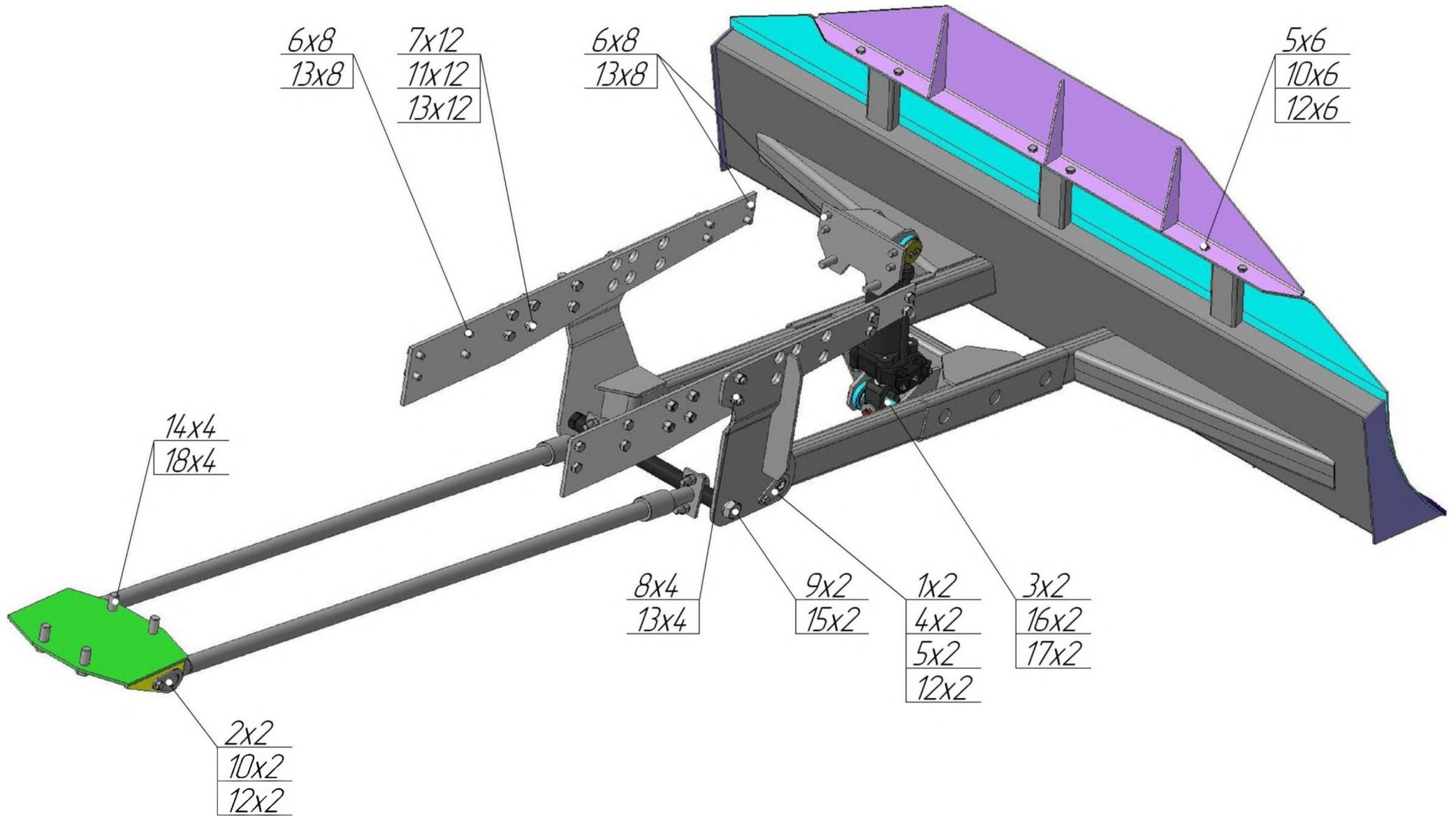
Рисунок 5. Отвал жесткий ОЖ-82П
