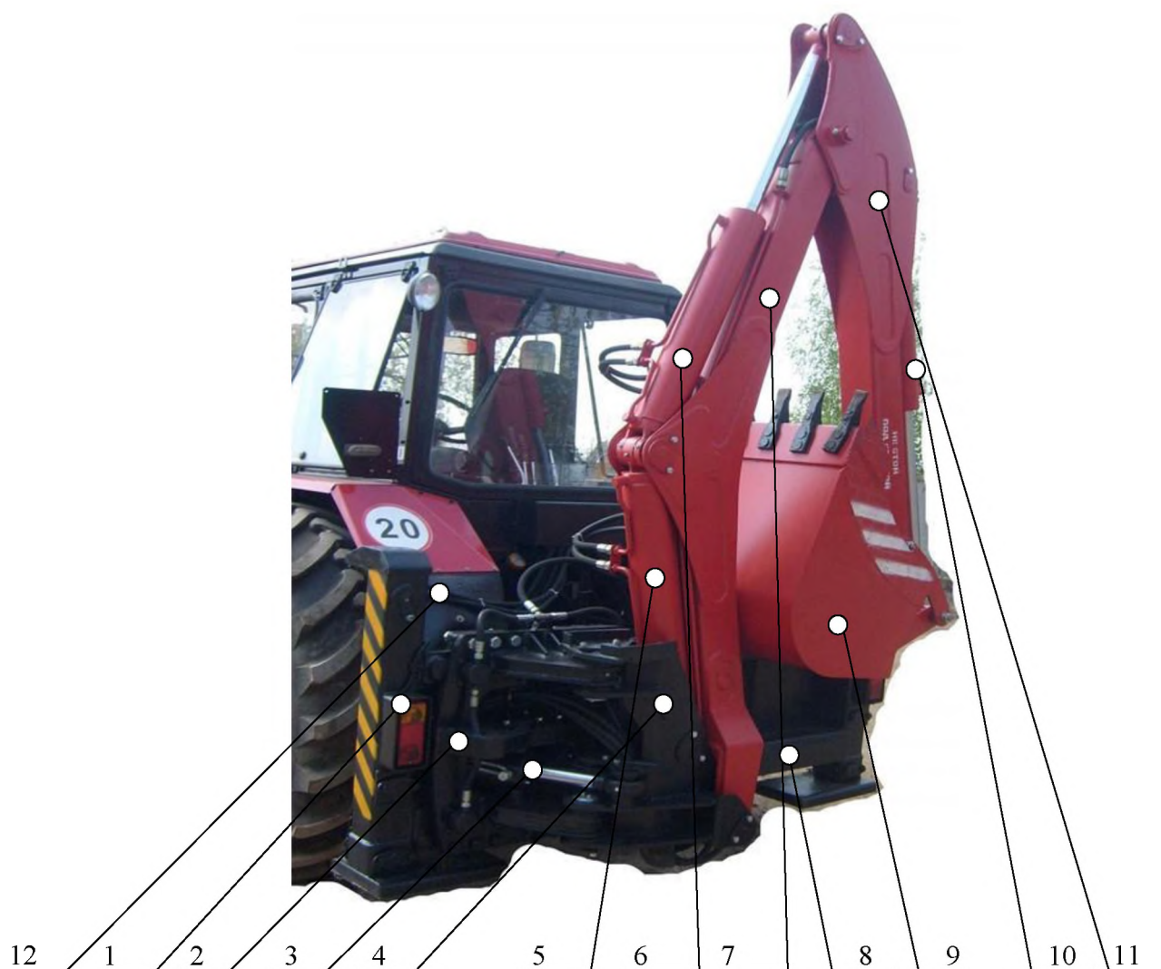
Рисунок 2. Общий вид и основные узлы Оборудования экскаваторного ОЭО-19(-02)
