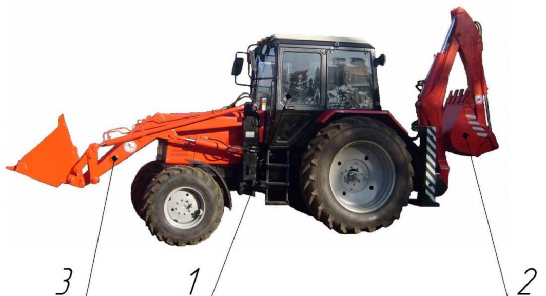
Рисунок 1. Машина для выемки грунта ЭБП-11 и ее исполнения.
